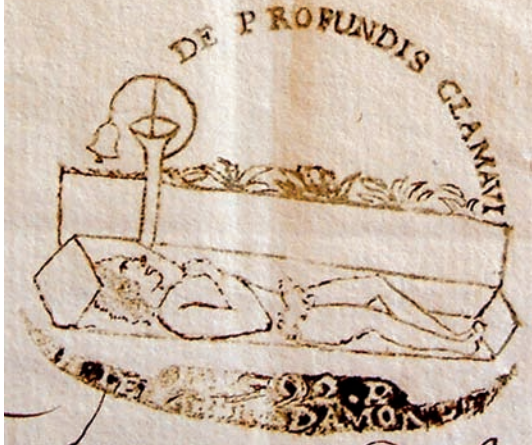
PLANCHE IX. — Projet de dispositif pour rappeler à la vie une personne prétendue morte qui ne serait qu'en léthargie. Dessin de Damond, 1807 (F 8 91, dossier 22).
