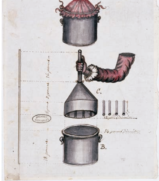
PLANCHE XVI. — Ventilateur pour projeter du gaz vinaigre et les esprits volatiles de la lavande. Dessin du médecin Cabanis, 1810 (F 8 151, dossier Cabanis).
