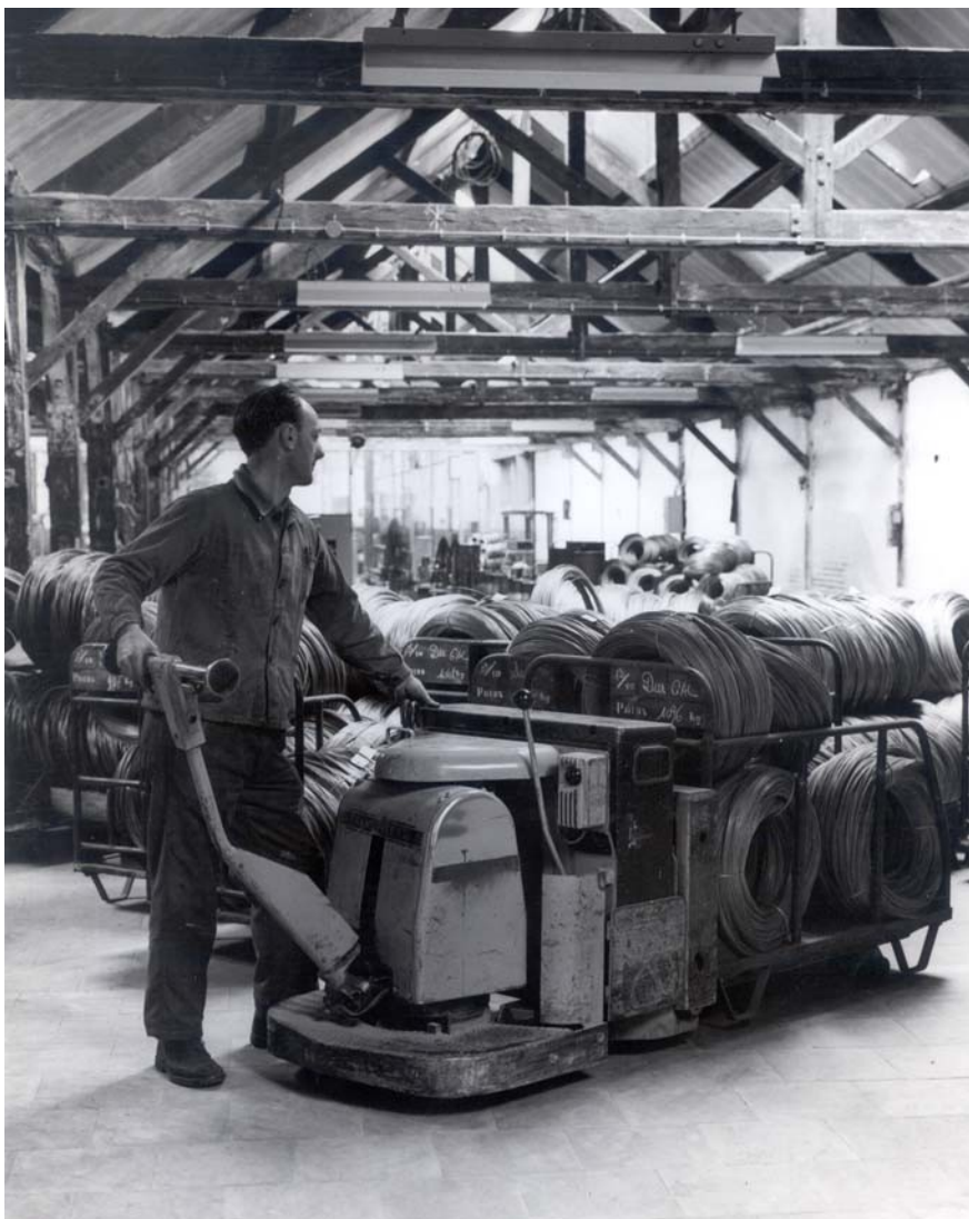
Manutention de bobines de câble avec chariot à bras motorisé (s. d.). Cote 2006 003 041
