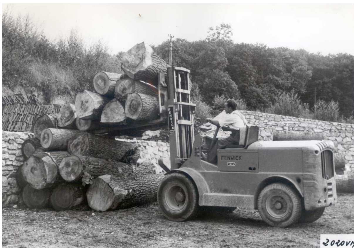
Manutention du bois avec chariot élévateur à fourches (s. d.). Cote 2006 003 141
