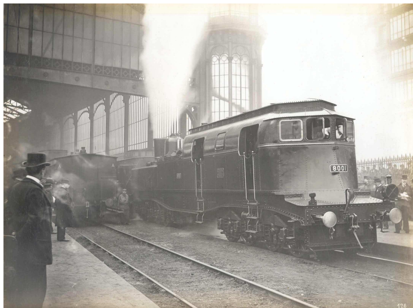
Essais de la locomotive électrique Heilmann n°2 dit e « 8001 », départ de la gare Saint-Lazare (1897). Cote 2005 060 037.
