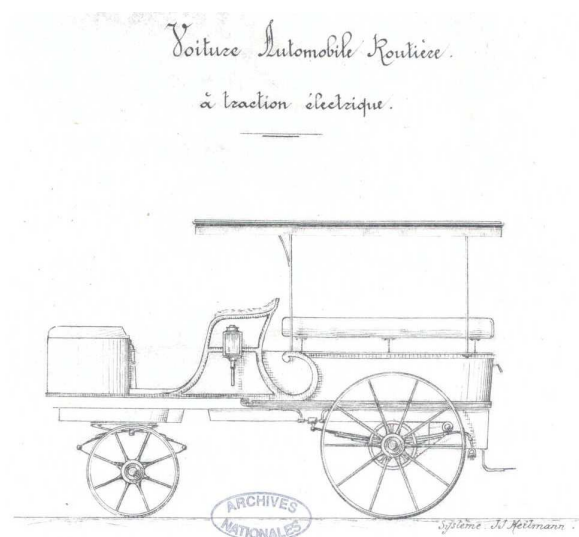
Dessin d'une voiture électrique Heilmann (1897). Cote 2005 060 019.
